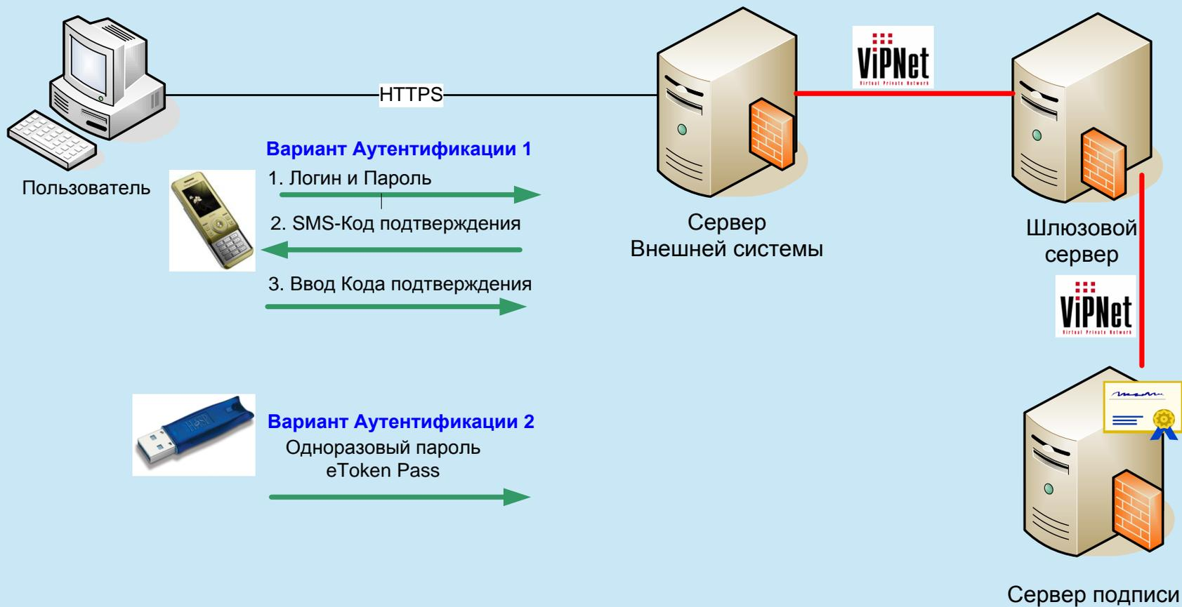
HSM ViPNet – аппаратный криптографический модуль, находится на стадии сертификации в ФСБ – обеспечивает генерацию ключей подписи, защищенное хранение без возможности извлечения, а также формирование подписи.
